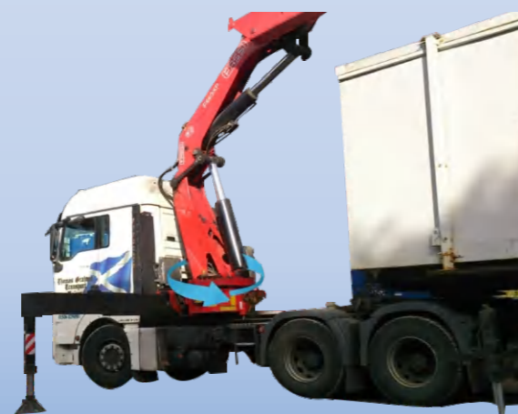
◆汽车吊 Truck crane
